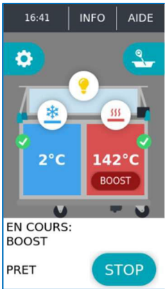
Boost terminé, retour en phase 4 MAINTIEN (Boost beëindigd, terug naar fase 4 WARMHOUDEN)
