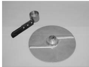
piatto di espulsione e/o espulsore
